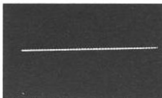
Fig. 1b : Résidu alternatif obtenu après passage à travers les régulateurs, l'amplificateur étant soumis à un signal carré de 1 kHz à pleine puissance. Echelle verticale 20 mV/div.
